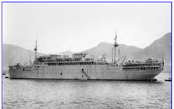
Le croiseur-auxiliaire XI, ex-Aramis dans la baie de Hong Kong en février 1940. On distingue parfaitement son armement: 8 canons de 138,5 mm et au moins 2 pièces de DCA sur la dunette
